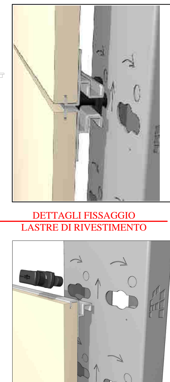
PARTICOLARE SEZIONE SU RIVESTIMENTO PARIETALE - scala 1:20
